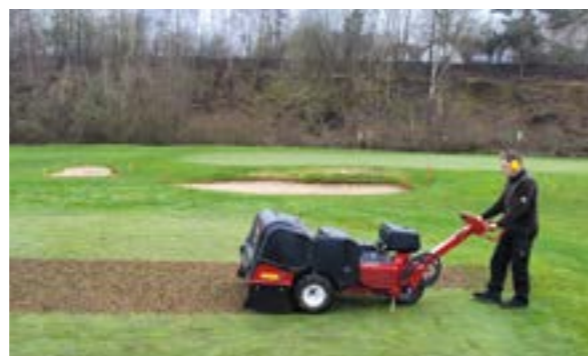
Mit einem selbstangetriebenen ProCore werden die Löcher in die Grüns „gestanzt“. (Alle Fotos: Privat)
